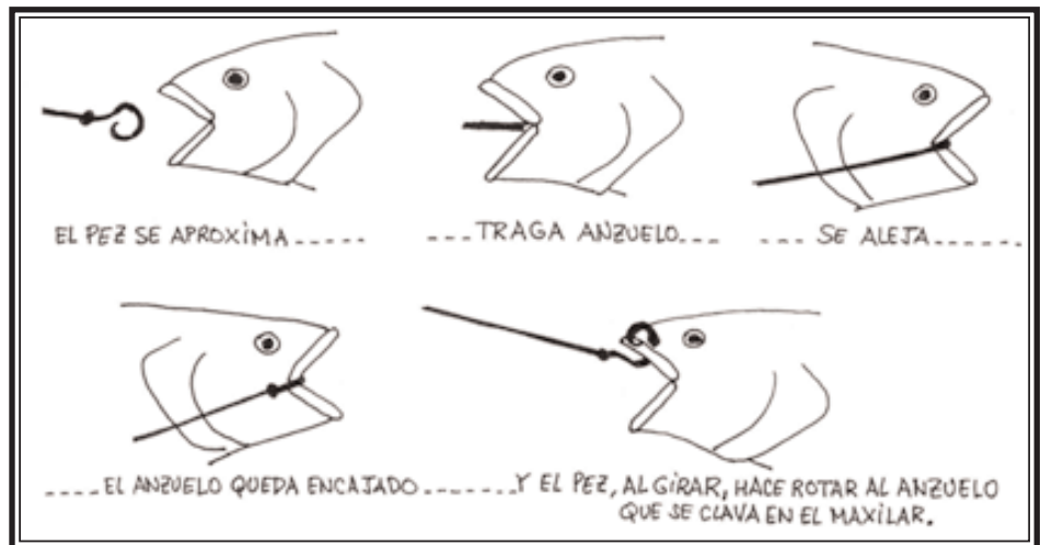
Figura 16. La teoría de cómo actúa el anzuelo rotador (Tomado, con modificaciones, de Leach, 2006)
