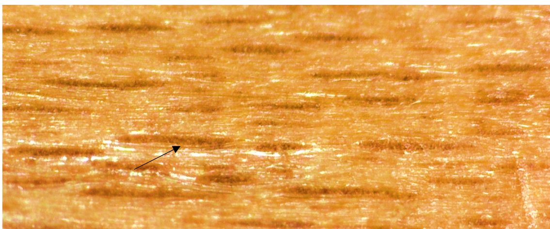
Figura 9. Sección longitudinal de viga. Se trata de la muestra 7, presentando fibras no septadas y de pared gruesa, entre 4 y 12 mm de largo (flecha negra). Por tanto, son más delgadas que las del algarrobo.
